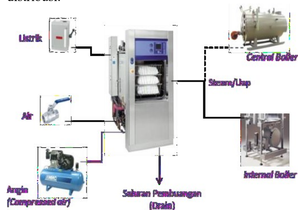
Gambar 1. Komponen pendukung mesin sterilisasi
